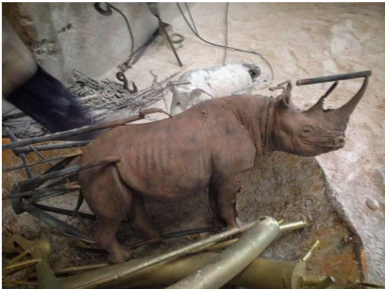
"La belleza negra / The Black Beauty ". Instagram Recién salido del molde de yeso, aún con los embudos / Just out from gypsum mould, still with funnels
