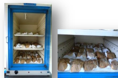
Figuras 10 y 11. Paso 1, donde se puede apreciar las muestras secándose en la estufa, envueltas en papel de filtro y señalizadas.
