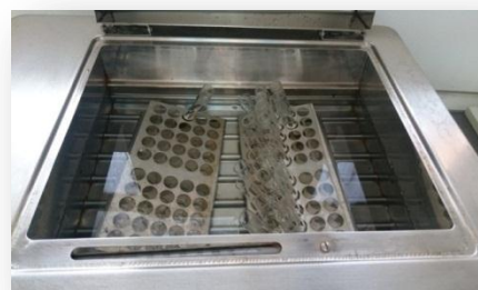
Figura 13. Muestras evaporándose en el baño de agua a 100°C (pasos 9, 11 y 12).
