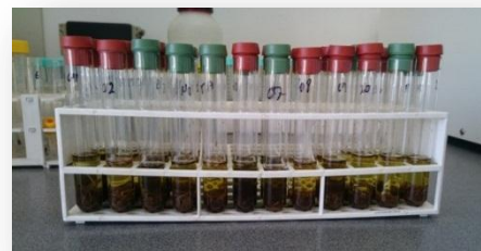
Figura 12. Tubos de extracción identificados con los 0.2 g de muestra, 0,5 ml de agua destilada y 4,5 ml de etanol absoluto (EtOH).
