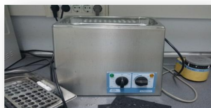
Figura 14. Sonicator, en el que se separan las partículas de la pared de los tubos (pasos 12 y 13).
