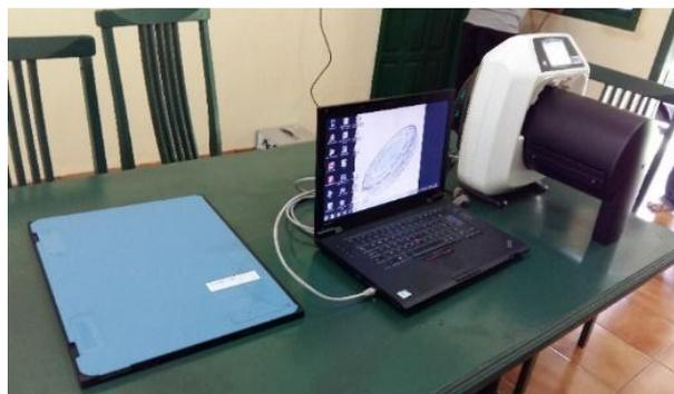
Gambar 3 Seperangkat *computerized radiography* yang terdiri dari kaset (film), laptop dan *scanner* (dari kiri ke kanan).
